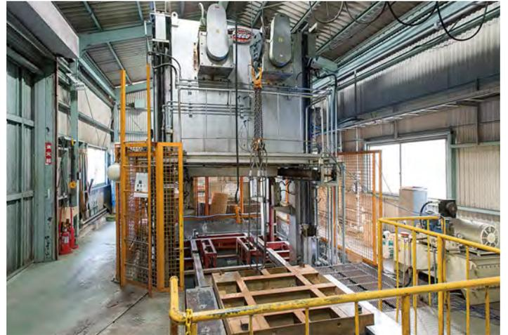
熱処理は、アルミニウム合金のT4・T5・T6・焼鈍などに対応しております。弊社では、材料の装入～溶体化～焼入～焼戻～取出の工程をあらかじめ設定されたサイクルで全自動運転しております。熱処理条件については、要求品質に応じた熱処理条件を策定しています。
