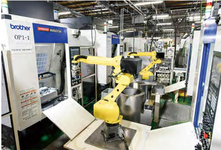
機械加工部門では、当社で鋳造した製品を主に加工しています。NC旋盤及びマシニングセンターを基本にし、数量が多いものには専用機も導入し、加工を行なっています。試作加工から量産加工そして、アッセンブリまで対応しております。
