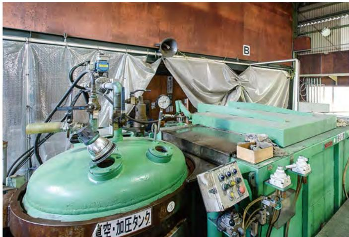
含浸処理とは、鋳物の巣などに樹脂を注入し、硬化させ、その不要な穴を塞ぐ処理です。鋳造品には目に見えないピンホール（鋳巣）等が存在し、圧力のかかる部品では、水漏れ、油漏れの原因となります。このような部品のピンホールを樹脂で含浸・封孔して、漏れのない部品、ピンホールの無い部品へと変えていきます。弊社では、有機含浸加工をおこなっております。
